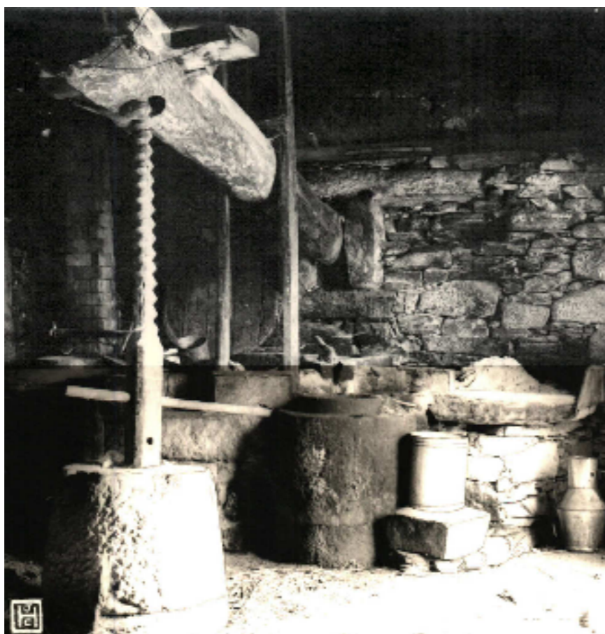
Figura 116: Prensa de vara do lagar de Vila Viçosa, P. 116, conc. de Arouca. A meio da prensa, abaixo da sertã, o pote para decantação.
