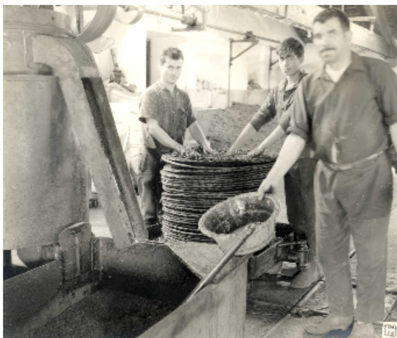
Figura 111: A massa é retirada do gamelão para uma gamela circular, vertida sobre o capacho e espalhada à mão (Quinta da Portela, P. 285b, freg. Stº António dos Olivais, Coimbra).
