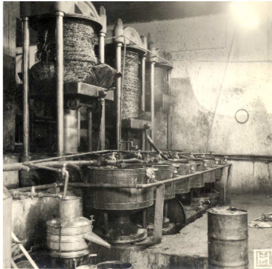
Figura 94: Prensas hidráulicas de um moderno lagar (Castelo Viegas, P. 288, conc. e dist. de Coimbra).
