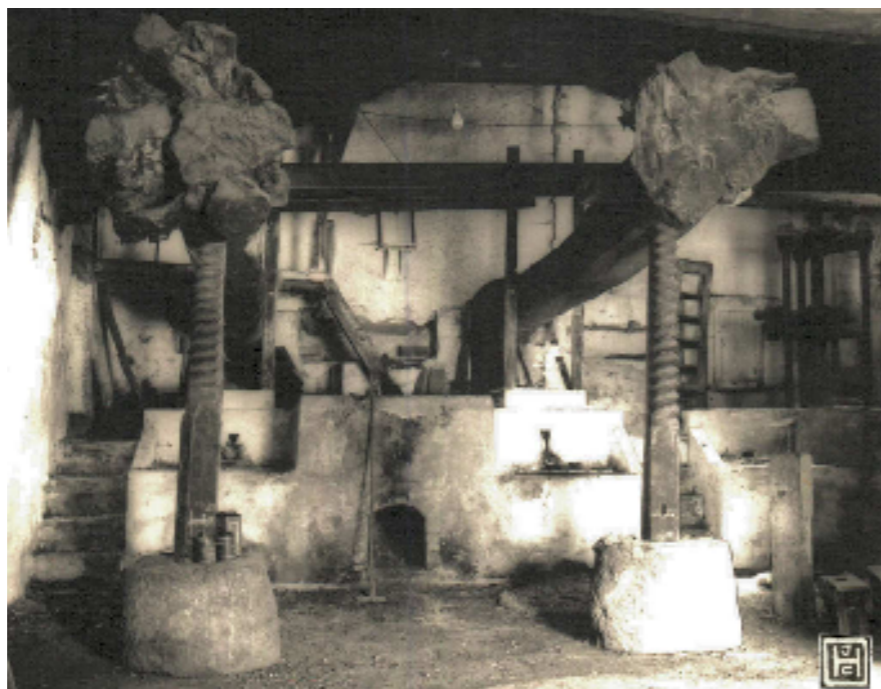
Figura 132: Lagar do Pereiro, P. 262, freg. Souselas, conc. Coimbra. De cada lado da fornalha, as duas tarefas, entre a zona de enseiramento e o fuso da vara.
