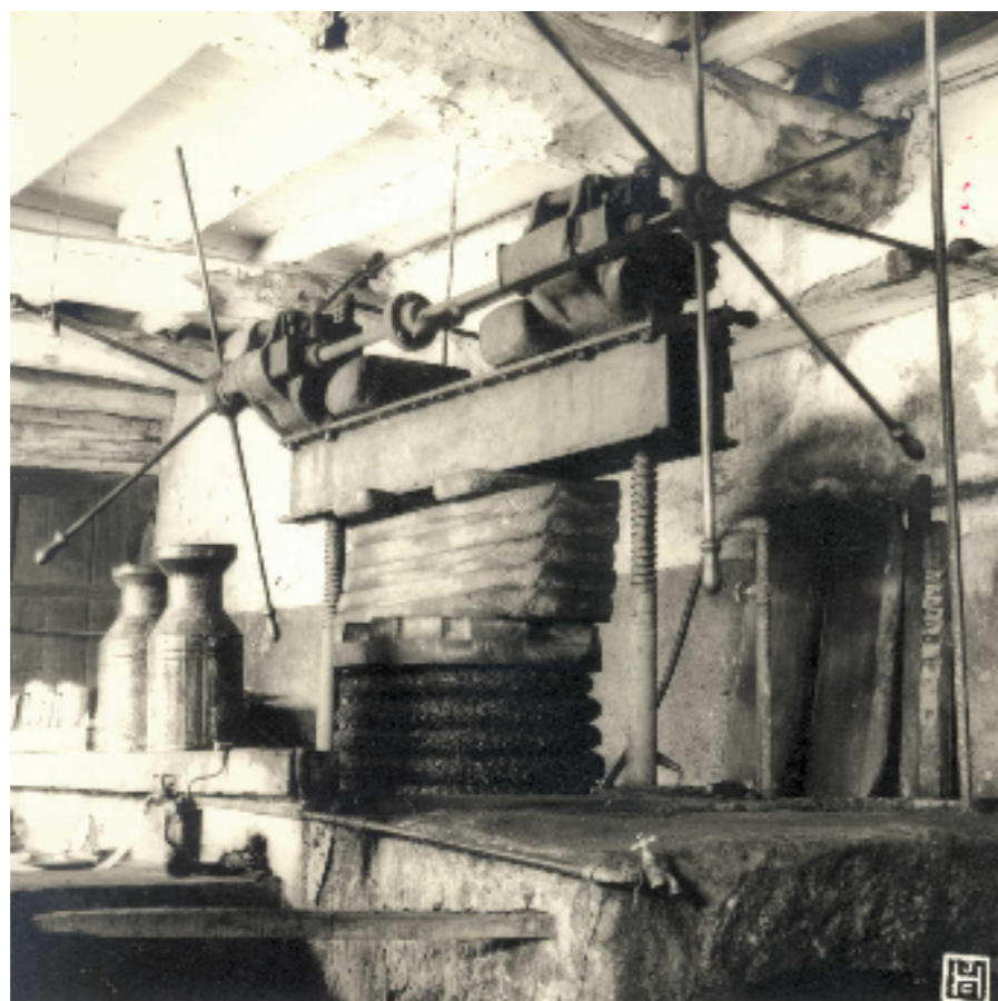
Figura 107: Aspecto da prensa de parafuso do lagar de Anterronde (P. 120, freg. Santa Eulália, conc. Arouca, dist. Aveiro).
