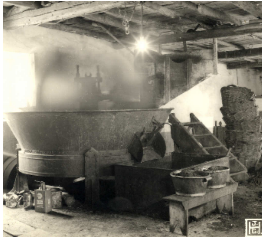
Figura 65: Moinho do lagar de Assafarge. Sobre o bordo da base, a espera da base. À direita, no 1º plano, as bacias da massa; ao fundo, os poceiros e o escadote da espera da base (P. 284, Coimbra).
