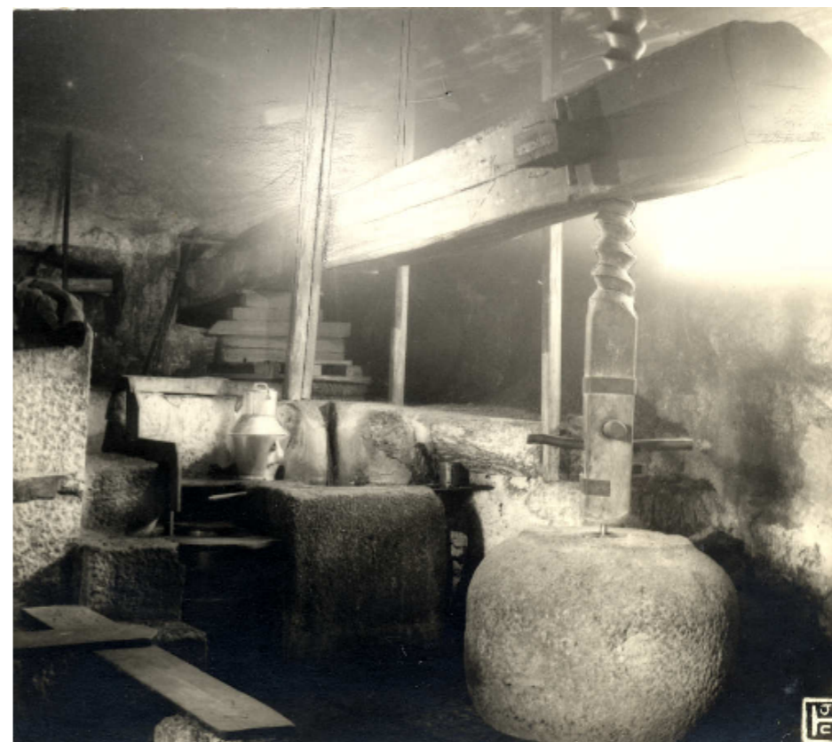
Figura 84: Prensa de vara de um lagar de azeite (Fundo de Vila, P. 57, freg. Jasente, conc. Amarante, dist. Porto).
