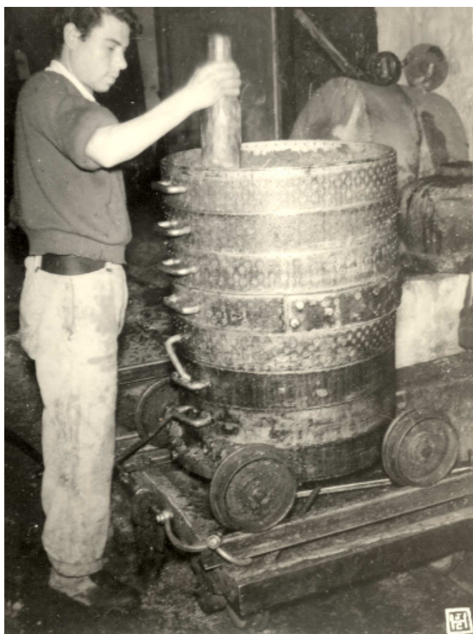
Figura 97: O bagaço é acamado dentro dos cinchos, antes de ir para a prensa (Fornos do Pinhal, P. 78, conc. Valpaços, dist. Vila Real).
