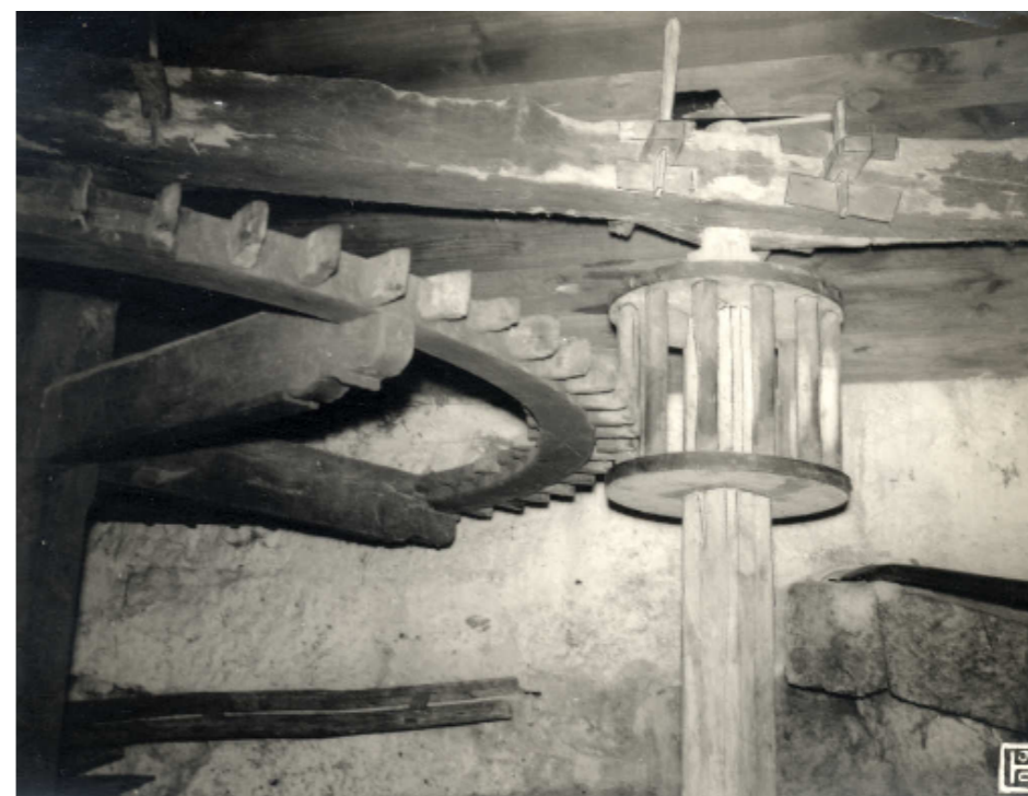
Figura 37: Sistema de transmissão formado por roquete (à direita) e roda da árvore ou pontaria (à esquerda), em Chacim, P. 29, freg. Refojos, Cabeceiras de Basto.
