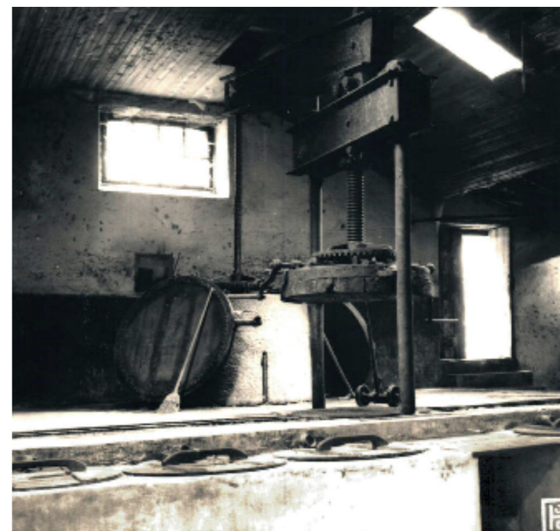
Figura 136: Prensa de parafuso e tarefas do lagar de Moura Morta, P. 294, freg. S. José das Lavegadas, conc. Poiares, dist. Coimbra.
