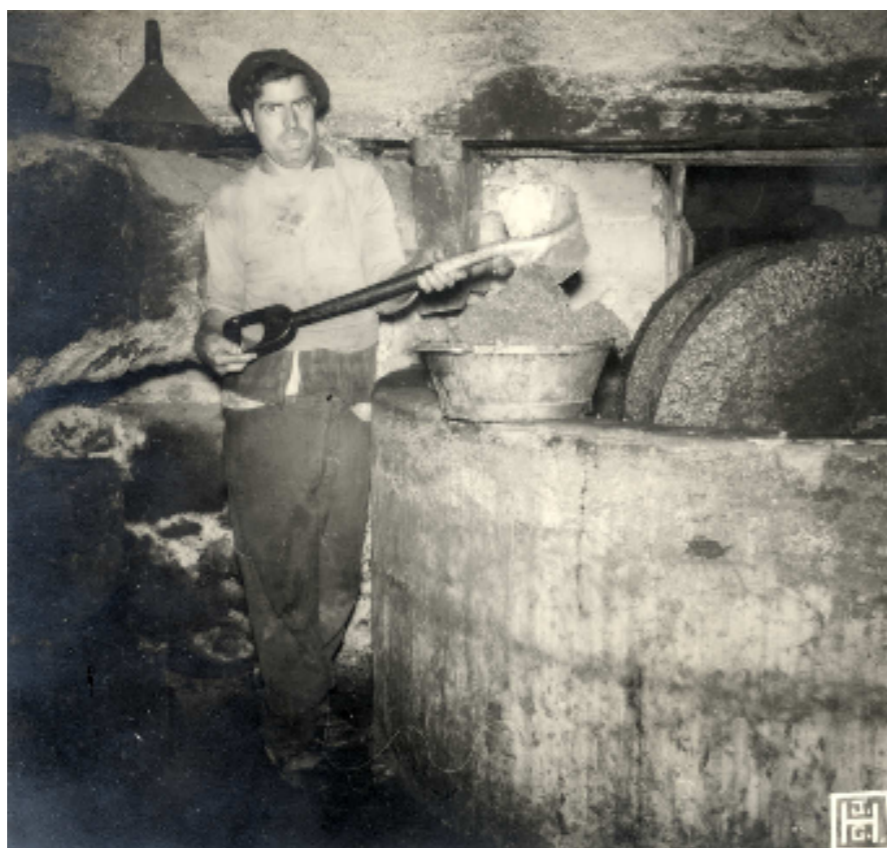
Figura 98: A massa é retirada do pio para uma gamela ou bacia de lata com uma pá vulgar (Mata, P. 297, freg. Vila Nova do Ceira, conc. Góis, dist. Coimbra).
