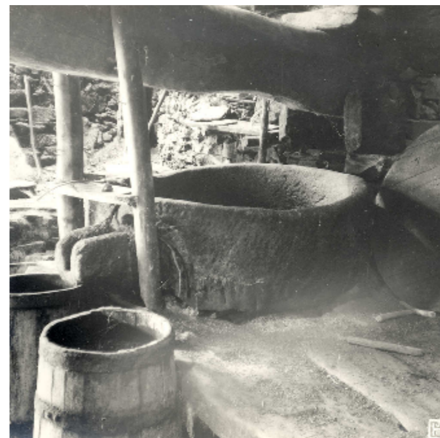
Figura 100: Aspecto da sertã do lagar de Canelas de Baixo, conc. Arouca, dist. Aveiro. No chão, à direita, os frades e a adufa; à esquerda, os potes ou tarefas.
