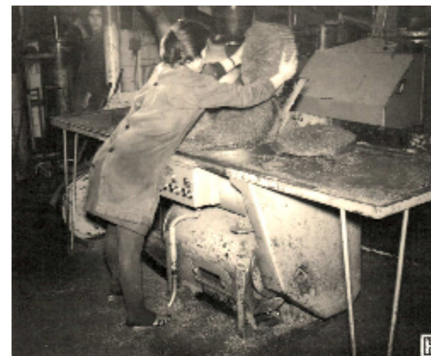
Figura 159: Máquina «destorroadora» para desfazer os torrões de bagaço saídos das prensas (Cachão, freg. Frechas, conc. Mirandela, dist. Bragança).
