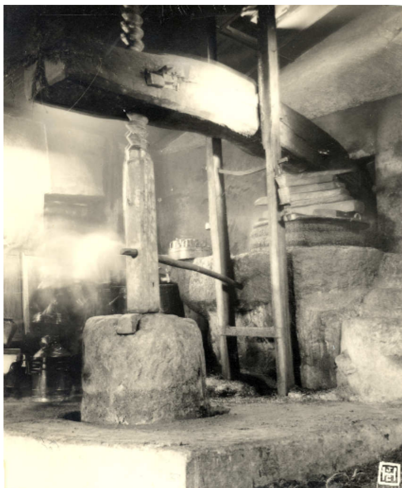
Figura 83: Prensa de vara de um lagar de azeite (Pedregal, P. 51, freg. Mesquinhata, conc. Baião, dist. Porto).
